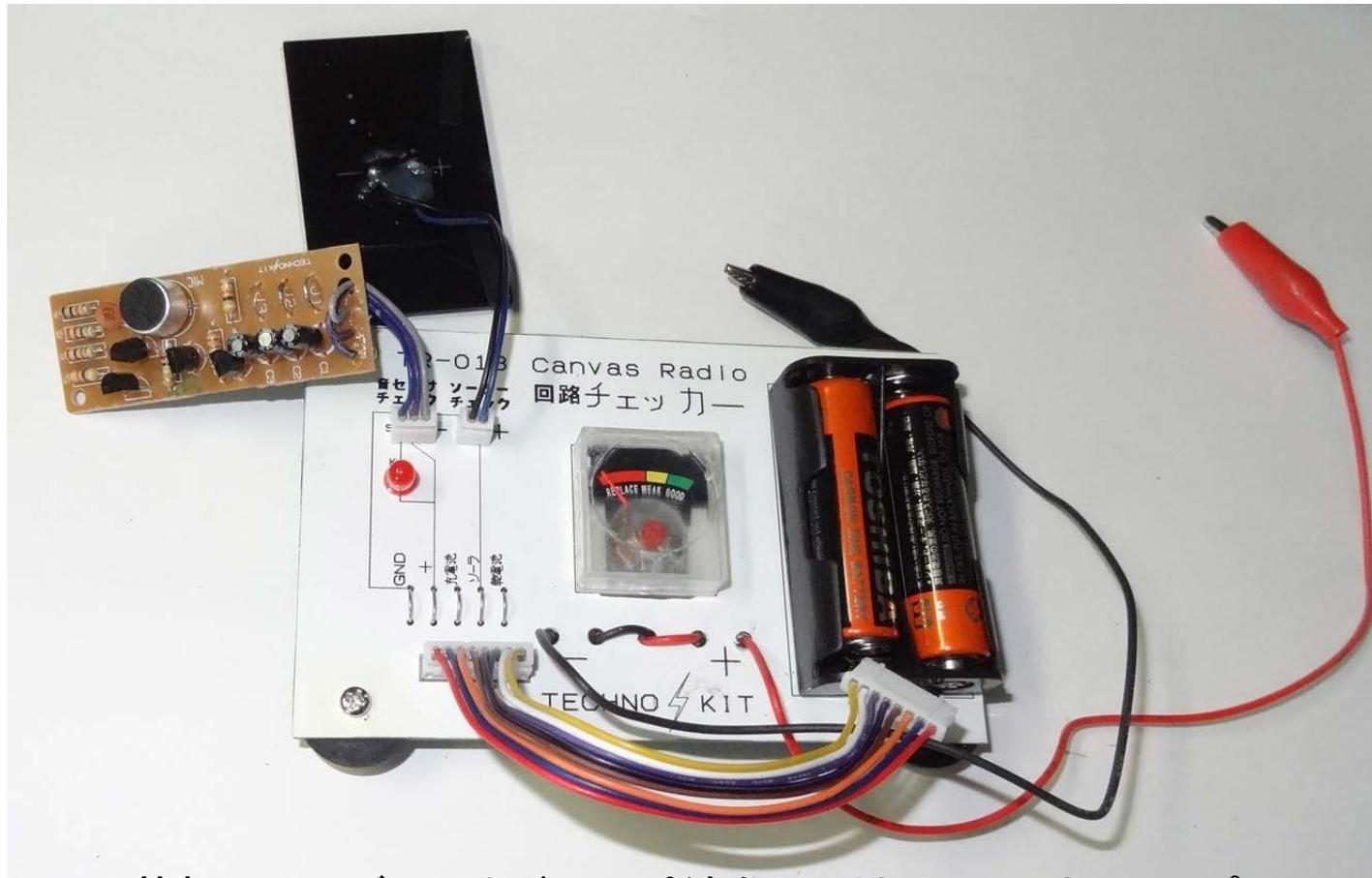
音センサ基板にコンデンサとジャンパ線を取り付けチェッカーの3ピンコネクタにはめます。マイクをコツンと叩くとLEDがしばらく点灯して消えます。点灯時間はコンデンサの容量で変わります。テストの時は小さな容量のコンデンサを有効にすると結果が速く分かります。
